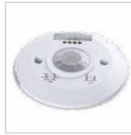
Kanlux ZONA FLAT to czujnik ruchu o maksymalnym zasięgu wykrywania ruchu 8m. Jego z kolei maksymalny horyzontalny kąt działania to 360 stopni. W czujniku ZONA masz możliwość regulowania czasu świecenia od 10s do 15min a także ustawienia poziomu natężenia oświetlenia otoczenia przy którym urządzenie będzie pracowało.
